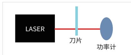
图5 刀口法测量原理图
