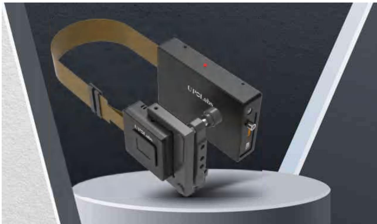
HDSL80R Pro液晶空间光调制器由驱动器、FPC柔性排线、LCoS温控器组成，搭配TEC控制器和LETO TEC CONTROLLER软件使用，可根据使用场景需求设定LCoS光学芯片工作温度，从而发挥理想的使用效果。
