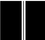
SLM软件模拟双缝缝宽10缝间距100 (pix)
