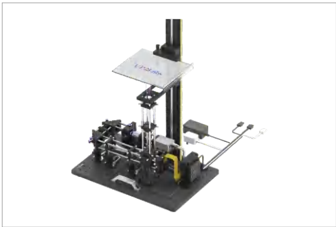
Holography-36R彩色全息实验系统装置图
