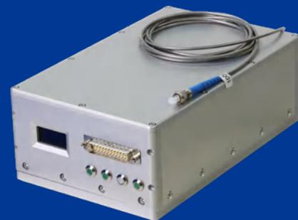
本产品通过采用创新的闭环控制系统，可在全操作模式下实现自动功率反馈调节，搭配主动温控技术实现了波长无跳模输出，同时具有高性能、低噪声、高稳定性、操作简单等特点。广泛用于半导体量检测、荧光激发、光谱分析、医疗分析等领域对激光器高强度连续工作需求。
