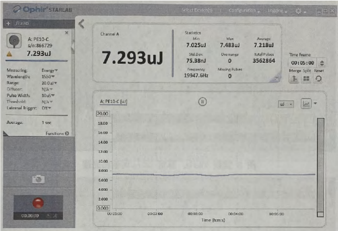
图 1-1 重频30kHz，脉宽120ns时的单脉冲能量
